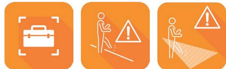
**Objekt- und Objektverlustdetektion (SOD), intelligente Bereichsüberwachung (PID), Liniendetektion (LCD):** Die SOD-Funktion detektiert Gegenstände, die in einem definierten Bereich hinterlassen oder aus diesem entfernt werden. Die intelligente Bereichsüberwachung (PID) schafft einen virtuellen Perimeter im Überwachungsbereich. Bei aktivierter Liniendetektion (LCD) löst die Überquerung einer virtuellen Grenzlinie einen Alarm aus.
