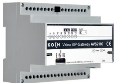
Das Video SIP-Gateway verbindet die klassische Video-Türsprechanlage TC:Bus mit einem IP-Netzwerk. Damit wird Türkommunikation mit IP-Telefon und Hausautomationsystem (mit integriertem VoIP-Softphone) möglich. Alles in einem Gerät – die Gateways AVS beinhalten einen Audio SIP-Server und einen Videoserver mit Bildspeicher. Für neue und bestehende TC:Bus Anlagen im Wohn-, Geschäfts- und Industriebereich.
