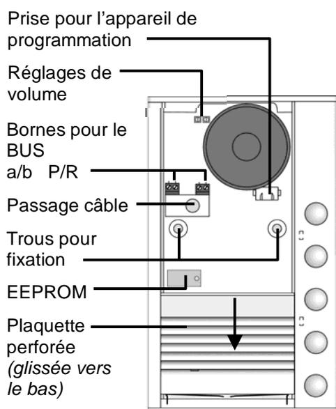
1. Retirer le verre de protection de la station extérieure. Glisser la plaque perforée (devant le haut-parleur) vers le bas jusqu'à ce que les trous de fixation soient visibles.
