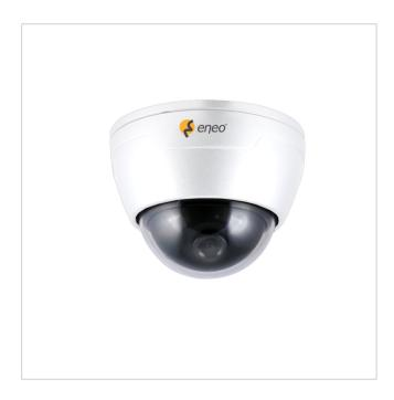
AES-5SF0036M1A 1/3" Mini Dome, Fix, klar, 3,6mm, 960TVL, 12VDC, vandalismusgeschützt, Aufbau
